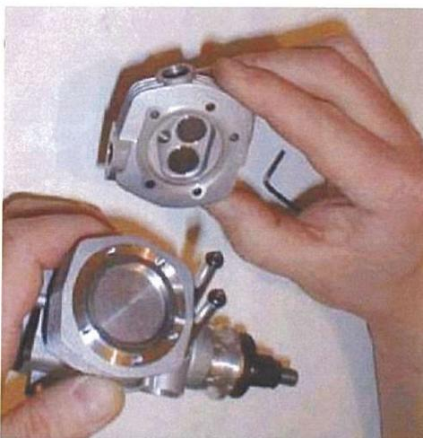
Adesso si possono smontare le cinque brugole della testata (notate sul block notes lunghezza diametro e disposizione delle brugole via via che le smontate), smontate la medesima facendo attenzione alle o-ring dei foderi delle aste che nel caso di un motore usato possono risultare incollate alla testata, fate attenzione inoltre alla guarnizione della testata una sottile rondella di alluminio.
